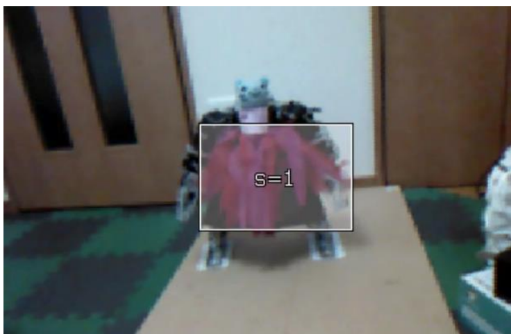
①カラーセンサ(PIXY2) 相手の追尾、間合いの判定 006
